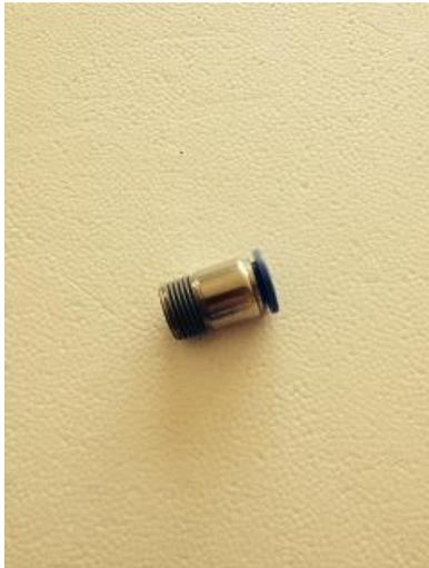
Durch „zurückziehen“ des blauen Ringes kann die Verbindung geöffnet werden. Durch die „Kralle“ bekommt das Rohr leichte „Riefen“. Daher Rohr - wenn - dann, nur bei Bedarf lösen und ggf. den Bereich abschneiden um wieder glatte Rohroberfläche zu bekommen.
